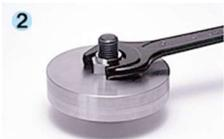
2) Utilizar una llave Torque o inglesa en la tuerca, para apretar la tuerca convexa al par de apriete apropiado para esta aplicación, puede apretar hasta su máximo limite.
