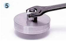
5) Ajustar la tuerca cóncava con una llave Torque o inglesa, según los valores indicados en la tabla N°1. En caso de no contar con la tabla, ajustar hasta que la misma se fije sobre la convexa.
